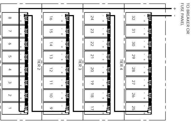
TYP 384V WIRING
